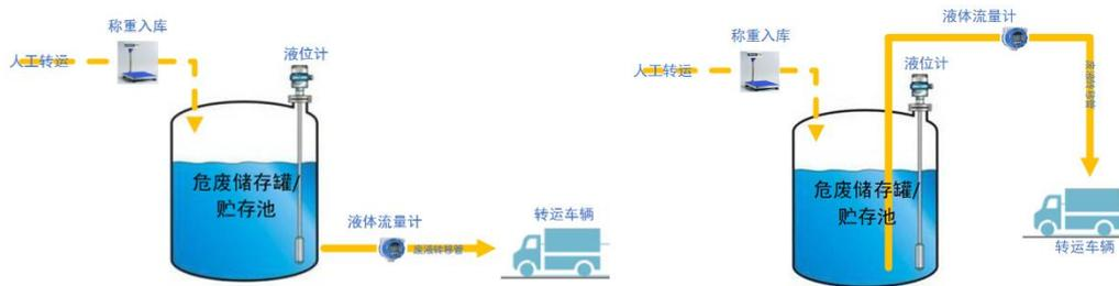
易燃、易爆危险废物贮存设施的监控设备需满足相关防护防爆要求，如贮存易燃、易爆危险废物的储罐/贮存池，流量计、液位计需满足防爆要求。
