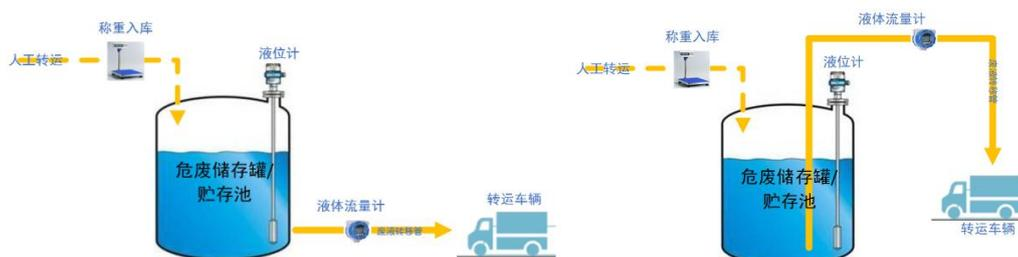
易燃、易爆危险废物贮存设施的监控设备需满足相关防护防爆要求，如贮存易燃、易爆危险废物的储罐/贮存池，流量计、液位计需满足防爆要求。
